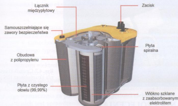
Rys. 4.6. Budowa akumulatora z ogniwami spiralnymi
