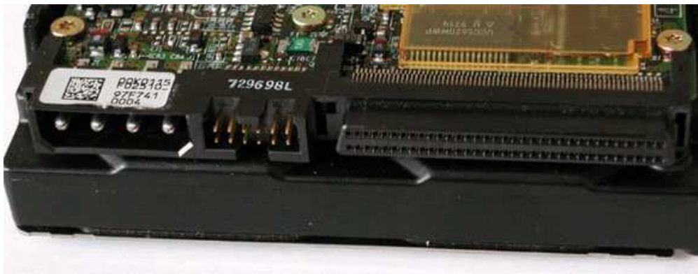
Blok złącz na dysku twardym SCSI: zasilanie, blok zwerek pomocniczych, taśma SCSI (od lewej do prawej).
