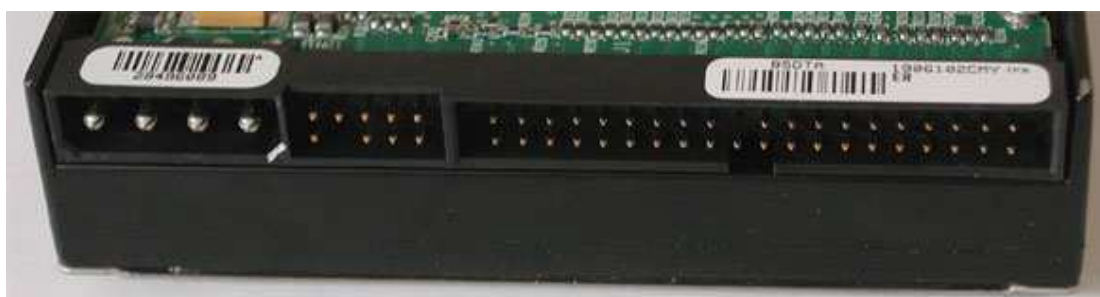
Złącza dysku twardego: zasilanie, blok zworek, taśma IDE (od lewej do prawej).
