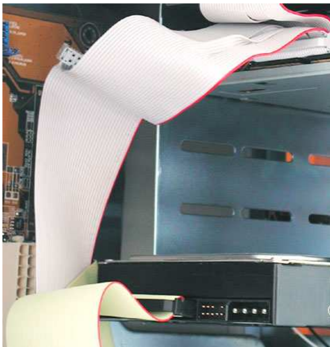
Tasiemki. Czerwone oznaczenia powinny być zwrócone w stronę złącz zasilających. Na dole: 80-żyłowa taśma do dysku twardego. No górze: 34-żyłowa taśma do napędu dyskietek.
