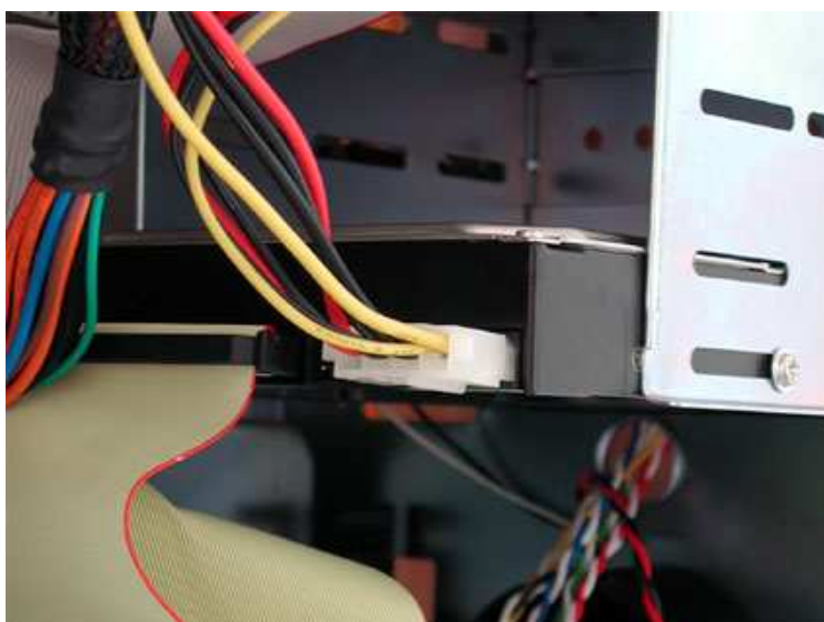
Cztery przewody dla dwóch napięć - 5 i 12 V. Złącze zasilania dysku twardego na prawo od kabla taśmowego.
