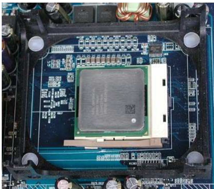
Płyty główne dla Pentium 4 posiadają gniazda z 478 kontaktami oraz prowadnicę dla radiatora.
