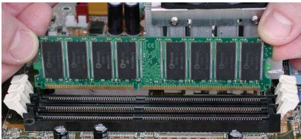
Instalacja pamięci RAM. Nacięcie na dole modułu pamięci zapewnia, że zostanie on odpowiednio umieszczony w gnieździe. Nacięcia na modułach SDRAM, DDR SDRAM i RDRAM znajdują się w różnych miejscach.
