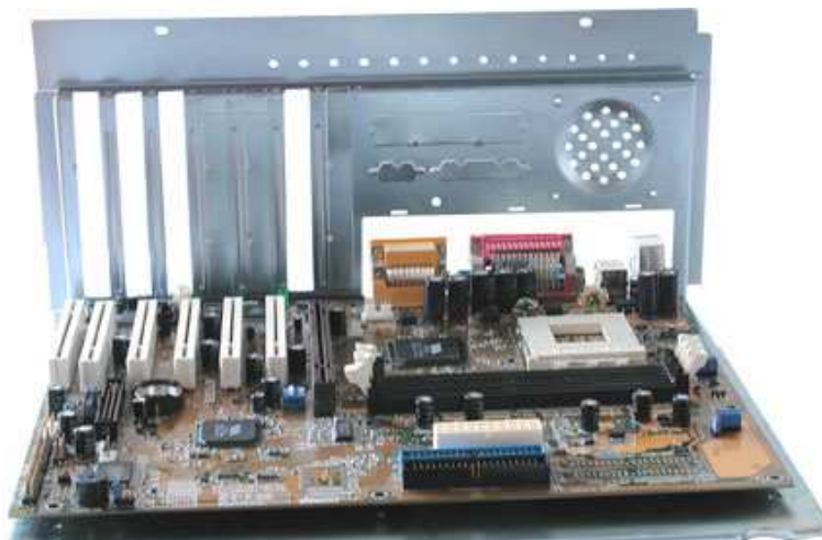
Dobrze oddalona od metalu - płyta główna na tacce montażowej.
